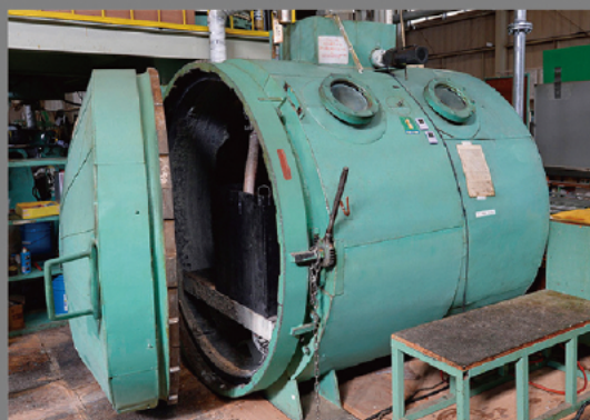
真空ワニス含浸設備
